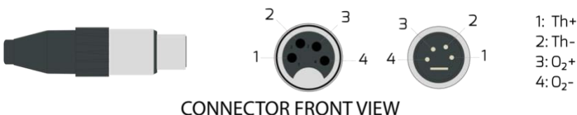
Fig 9: Connecteur électrique de CarboProbe™
